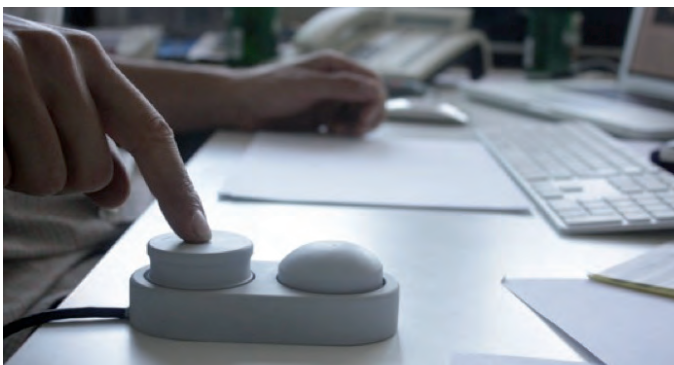
Abbildung 22. Betätigung des Drehdrückschalters um im ersten Modus die Linie auszuschalten und weiter zu arbeiten.
