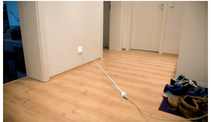
Abbildung 8. Die Rückwärtssteckdose wird aus der Wand gezogen (oben) und zieht sich wieder langsam zurück (unten).
