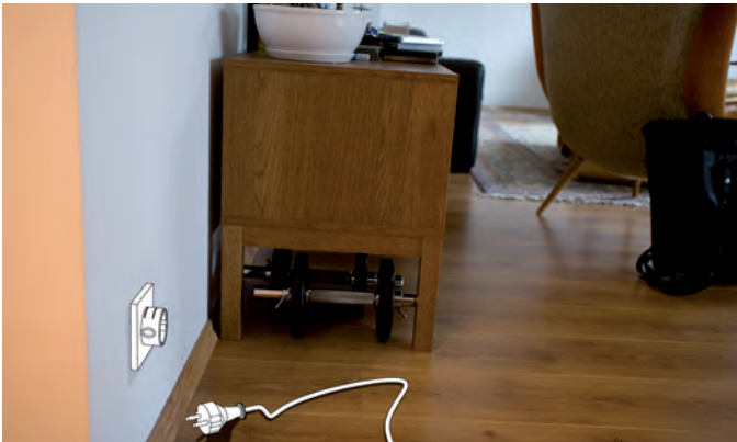
Abbildung 7. Nach einer zuvor bestimmten Zeit spuckt die Steckdose den Stecker aus. Der Stromfluss wird unterbrochen.
